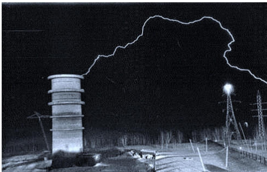
Прямое попадание искрой в действующую ВЛ-110 кВ (5 марта 1988 года).
