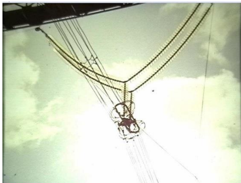
Макет одного из вариантов подвески в процессе испытаний на стенде СибНИИЭ.
